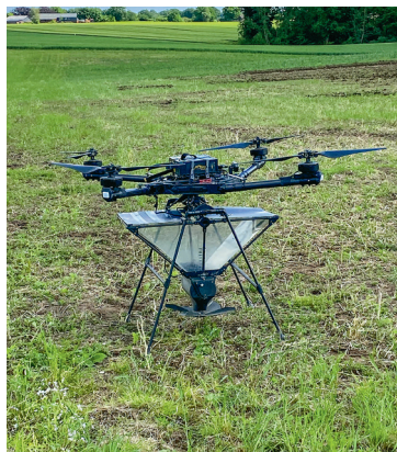
Drohne für die großflächige Aussaat von Saatgut zur Wiederaufforstung Fotos (4): jh
