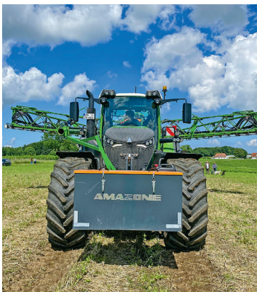
Nach einem Überflug per Drohne erhält die Feldspritze die Daten für eine punktgenaue Applikation.
