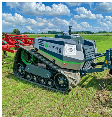
Autonom und bodenschonend unterwegs: der AgBot mit einer Leistung von 115 kW
